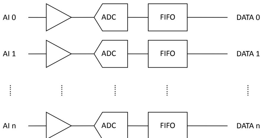
图 4.1 USB-4000 系列数据采集卡模拟通道原理结构图
