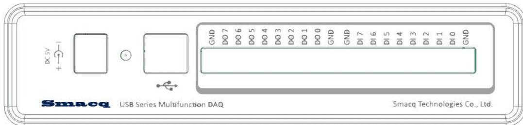
图 2.4 数字 IO 通道接线端口示意图
