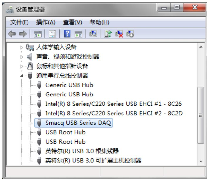
图 3.1、正确安装驱动之后的设备管理器显示图
