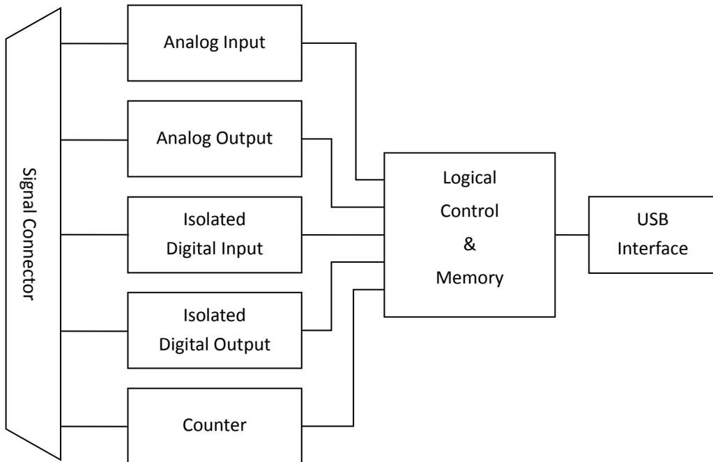
图 2.2 Smacq USB 系列数据采集卡功能结构图
