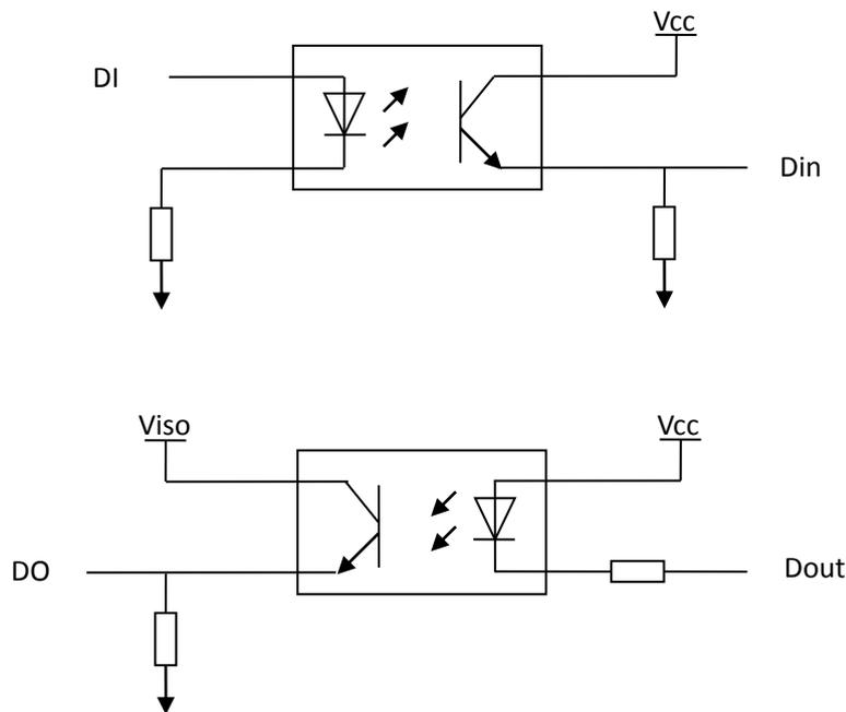
图 6.1 数字 IO 通道原理结构图
